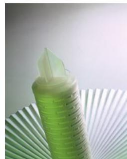
La cartuccia POLIXSTER è ottenuta pieghettando fino a 4 strati di filter media di poliestere a porosità a scalare che consentono di ottenere un grado di filtrazione molto preciso ed una elevata superficie filtrante. L'assemblaggio per sola termosaldatura assicura una struttura compatta e resistente anche a severe condizioni di esercizio.
